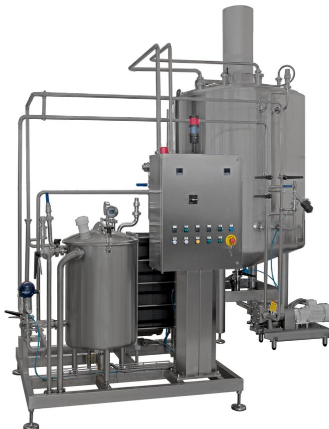
L'operatore può impostare il macchinario in 3 fasi di produzione tramite dei pulsanti a pannello, queste sono: preparazione, produzione e lavaggio.
