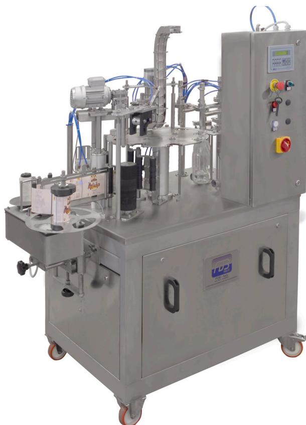
La macchina ha 5 stazioni operative e ha un funzionamento elettromeccanico, pneumatico-assistito.
