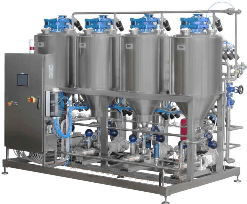
Questa configurazione consente di evitare le alte cadute di pressione e di controllare il processo di pastorizzazione con maggiore flessibilità. Possono fornire un flusso continuo di prodotto in entrata e in uscita, gestendo facilmente il tempo di mantenimento della pastorizzazione.
