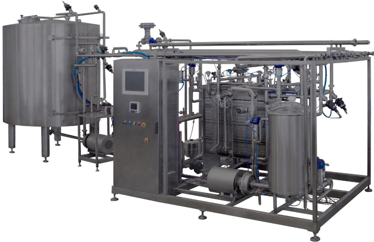
Gestiti tramite PLC su HMI con schermo LCD touch-screen da 12" e a colori dal quale è possibile controllare in tempo reale su P&ID lo stato delle valvole, lo stato delle pompe, la percentuale di apertura delle valvole modulanti, le temperature, le pressioni, la portata istantanea, i litri di prodotto processati, il livello nel serbatoio, lo stato del plc, etc.
