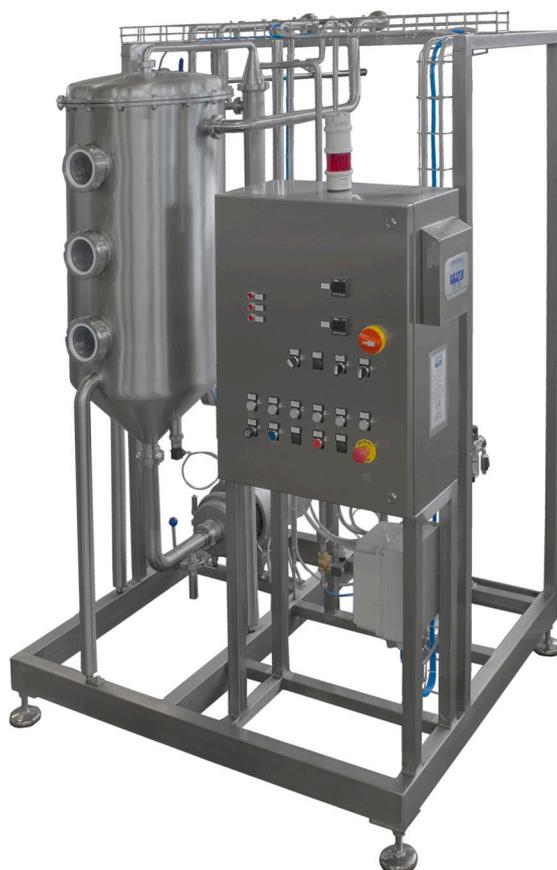
Il prodotto entra nella parte alta del serbatoio, viene distribuito sulle sue pareti con un'inclinazione tangenziale, in modo da creare un flusso laminare. Questo permette alla parte volatile del prodotto di separarsi e grazie al sistema di vuoto controllato presente all'interno del serbatoio, di venire rimossa dal serbatoio.
