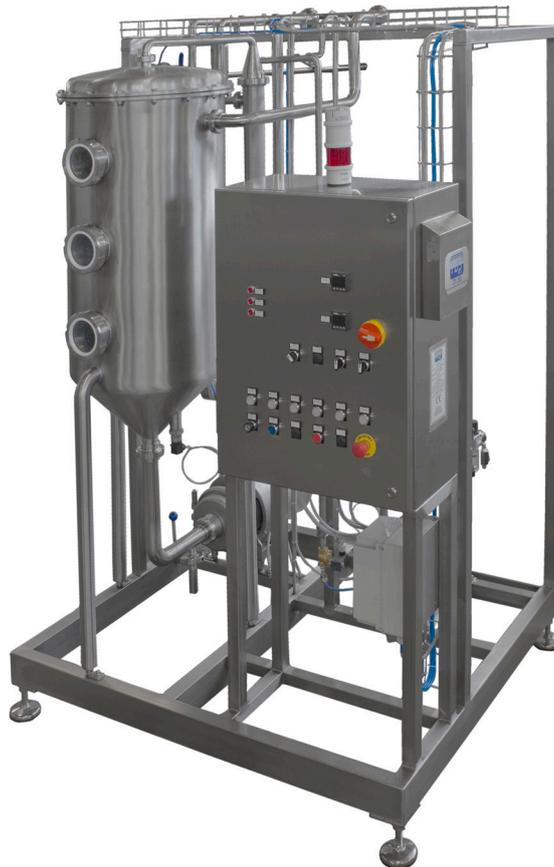
Il prodotto entra dalla parte superiore della vasca, si distribuisce sulle sue pareti con inclinazione tangenziale in modo da creare un flusso laminare. La parte volatile del prodotto è estratta attraverso un sistema di aspirazione sottovuoto. Il livello del prodotto nel serbatoio è mantenuto costante automaticamente mediante una pompa di scarico su inverter e flussimetro elettromagnetico.
