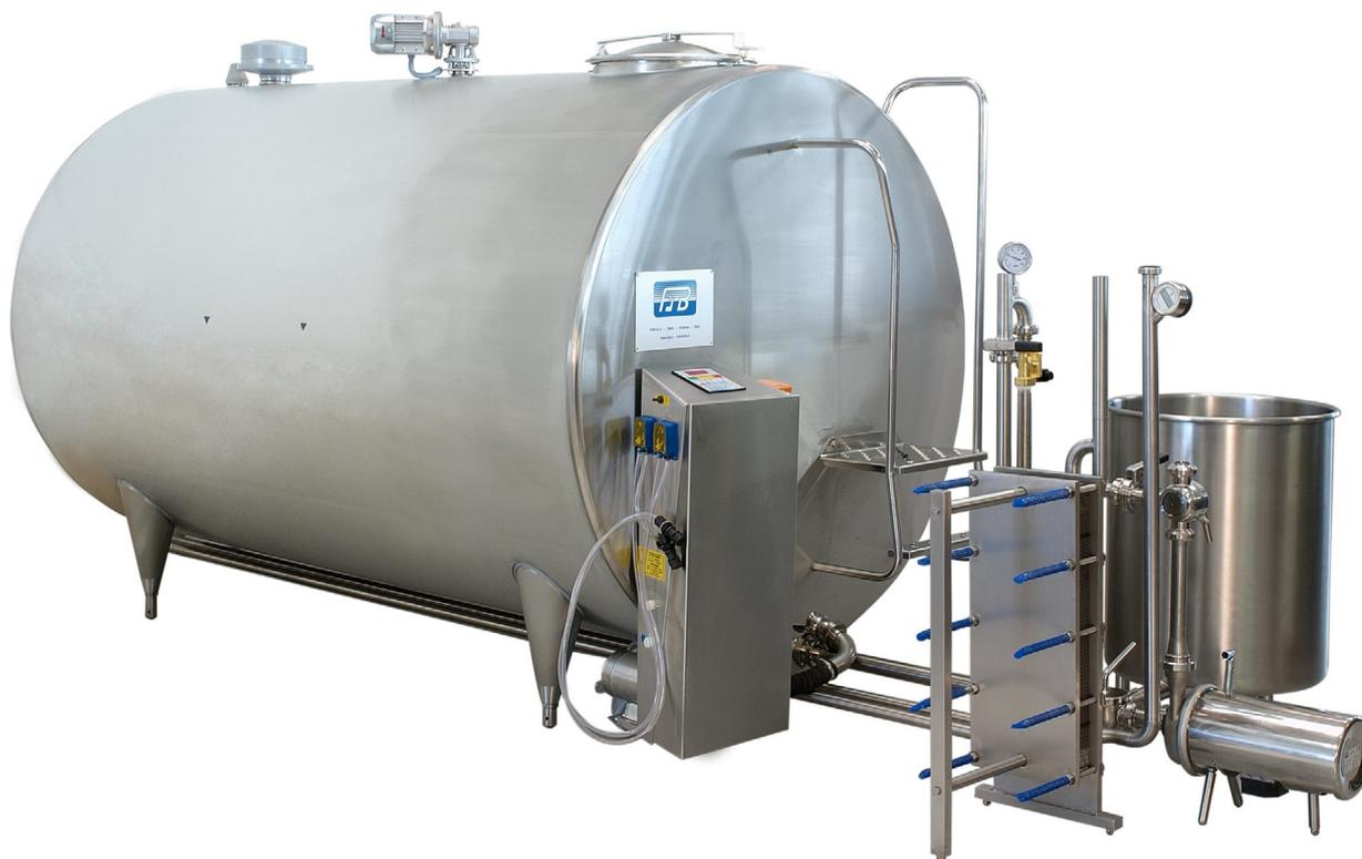
Serbatoi di forma cilindrica ad asse verticale (versione STV) e ad asse orizzontale (versione STH), con intercapedine "Trapcold" e coibentazione.
