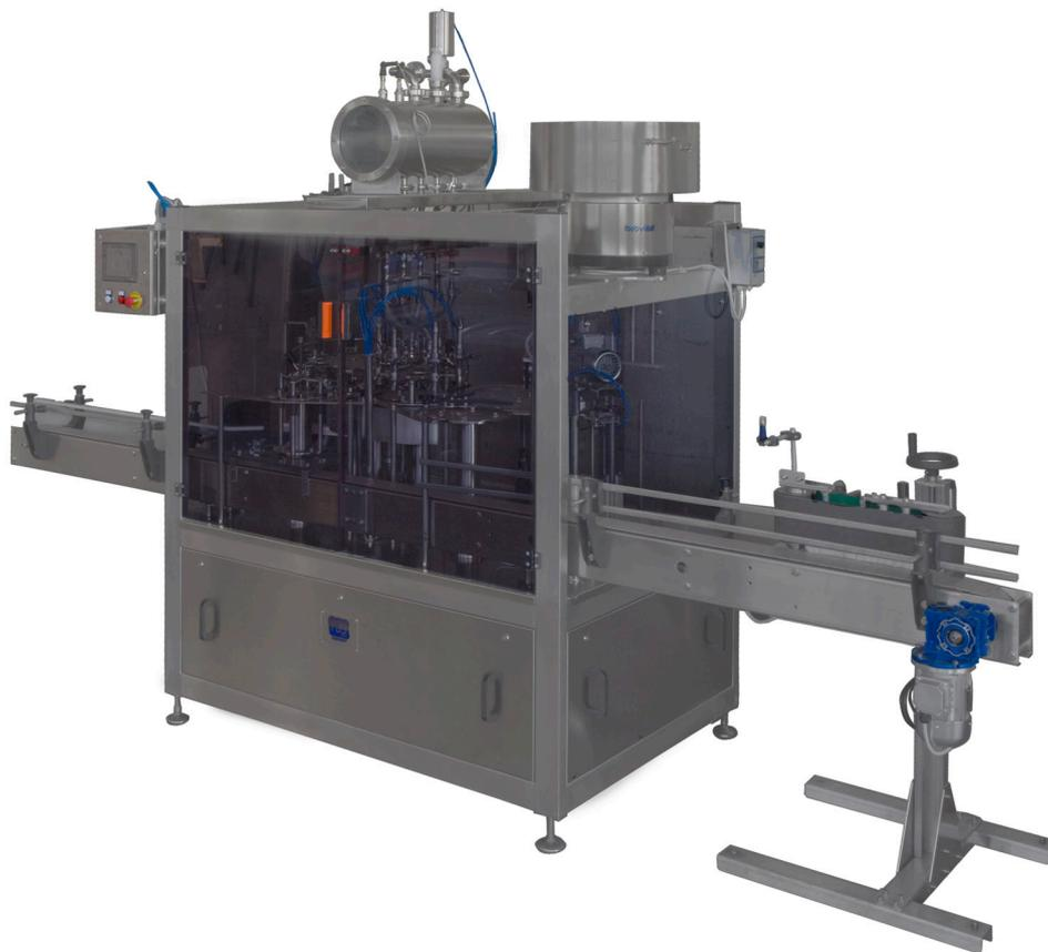
La macchina ha 8 stazioni operative e ha un funzionamento elettromeccanico, pneumatico-assistito.
