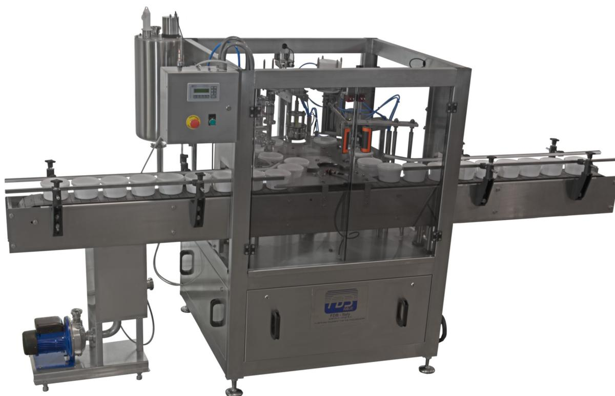
La macchina ha 8 stazioni operative e ha un funzionamento elettromeccanico, pneumatico-assistito. Ogni stazione ha più funzioni (dosaggio multiplo, etichettatura, ecc.). Più funzioni consentono di avere una macchina più flessibile e di confezionare più tipi di prodotti.
