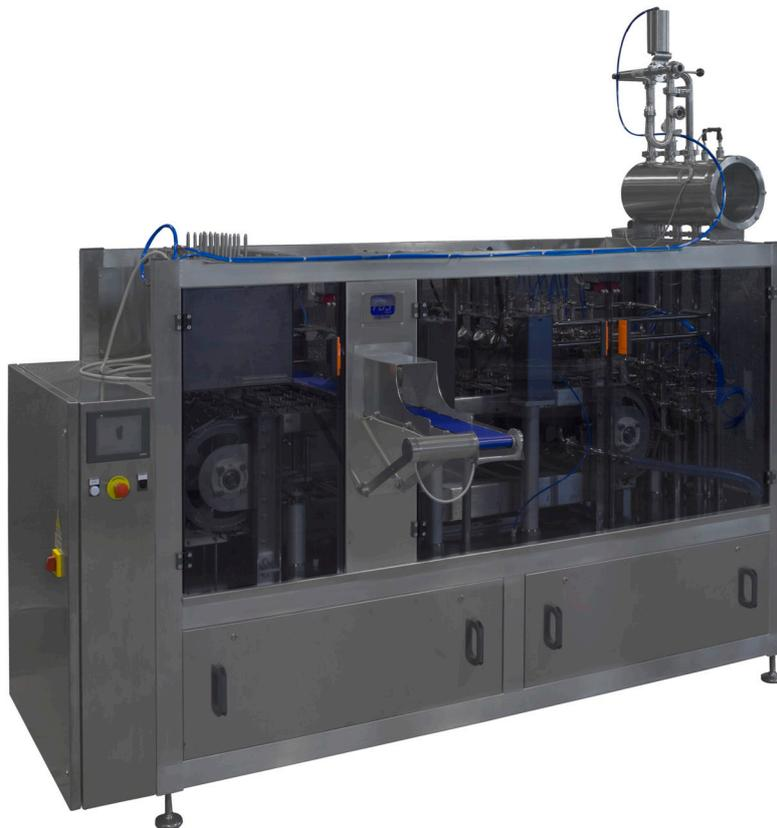
La macchina ha 9 stazioni operative e ha un funzionamento elettromeccanico, pneumatico-assistito. Ogni stazione esegue più funzioni (dosaggio multiplo, etichettatura ecc.). Più funzioni consentono di avere una macchina più flessibile e di confezionare più tipi di prodotti.
