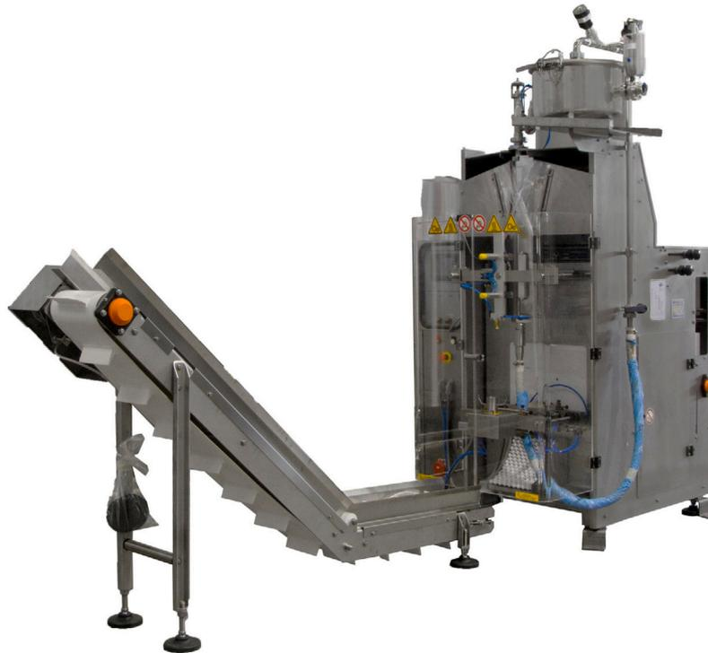
La macchina è progettata per funzionare in ambienti classificati come “aggressivi” a causa della presenza di umidità elevata, condensa e altri elementi che altrimenti causerebbero un rapido decadimento dei componenti meccanici. È realizzato in AISI304. È completo di pannelli in alluminio / policarbonato con microinterruttore di sicurezza e piedini regolabili in altezza.
